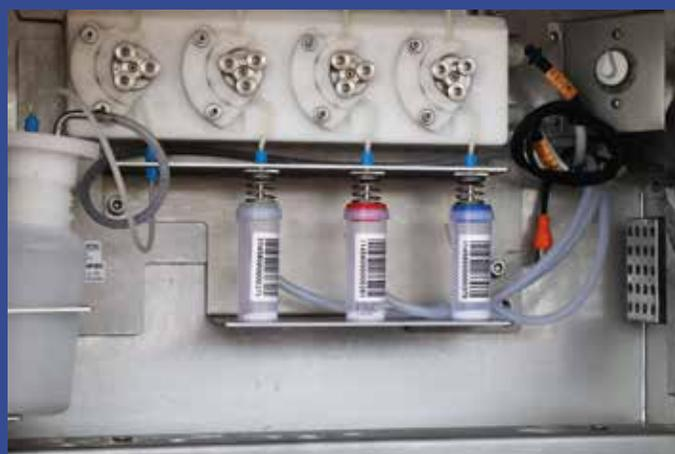
As amostras de controle e de qualidade são captadas automaticamente conforme o leite entra no caminhão.
